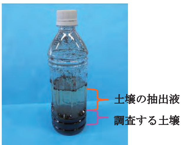
図 2-11. ペットボトルで攪拌した土壌
