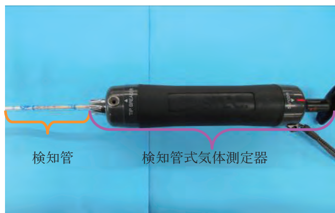
図 2-16. 大気中成分の測定に用いた検知管および検知管式気体測定器
