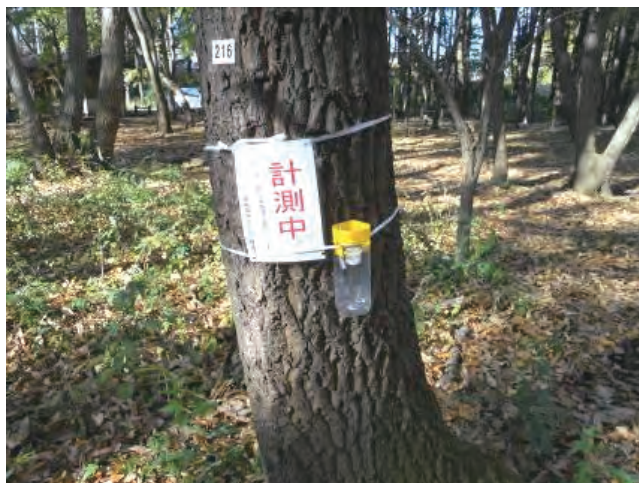
図 2-4. 樹木に設置した雨水採取用のペットボトル
