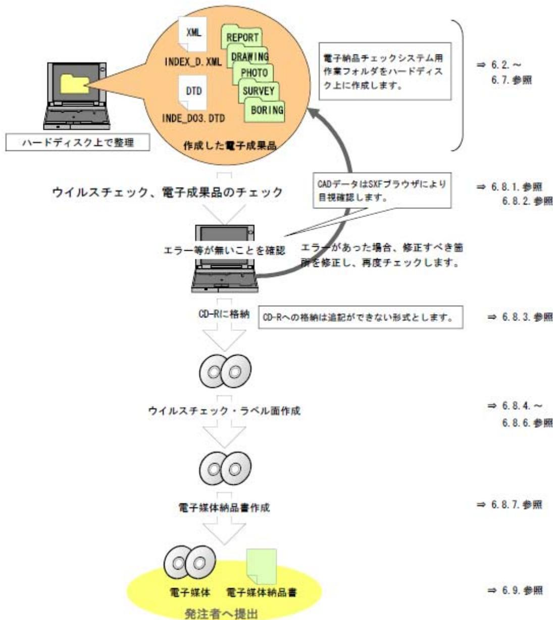
図 6-1 電子成果品作成から電子媒体提出までの流れ <sup>13</sup>
