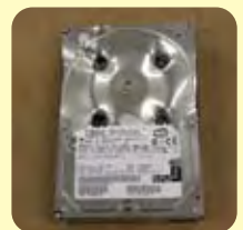
ハードディスクの破壊(穴あけ)例
