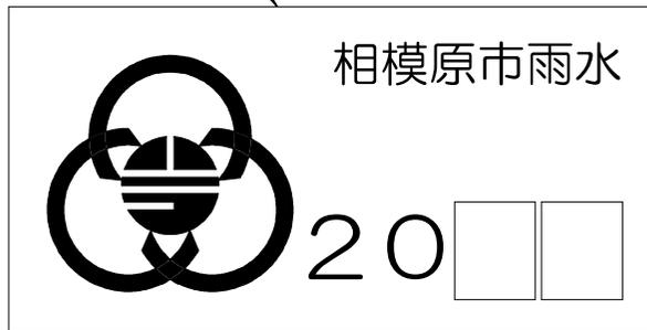
※雨水管の市章、文字は汚水管と同じものとする。
