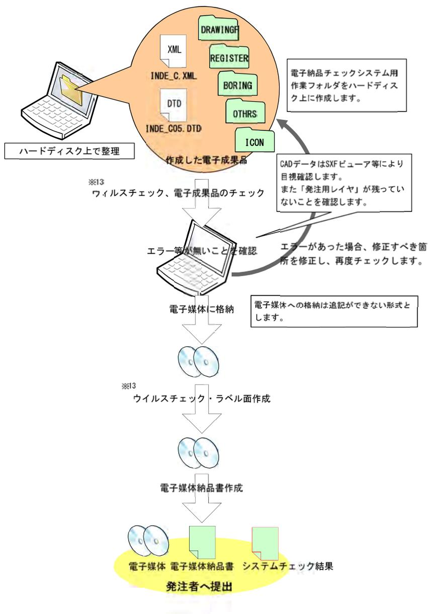
図 5-1 電子成果品作成から電子媒体納品までの流れ
