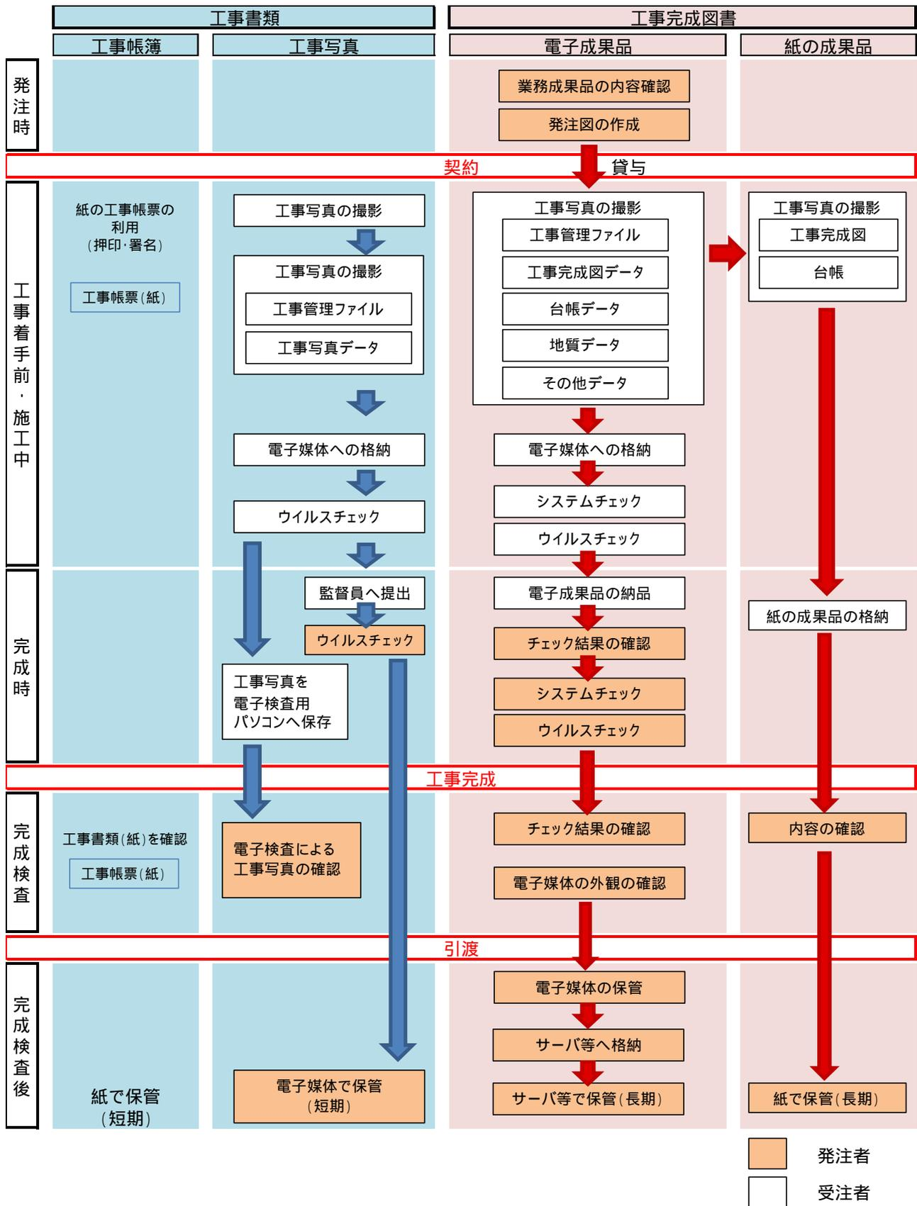
図 2-1 土木工事における電子納品・電子検査の流れ
