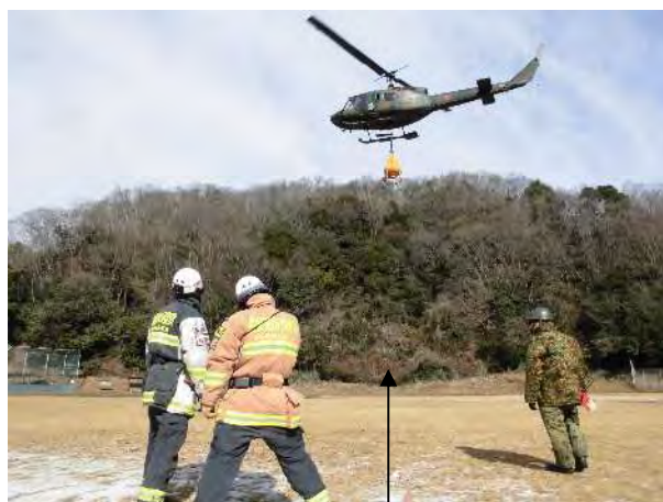
陸上自衛隊ヘリコプターに設置した「水のう」 （容量約700ℓ）
