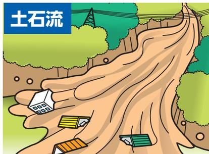
山腹や川底の石や土砂が、長雨や集中豪雨などによって一気に下流へと押し流される現象です。時速20～40kmという速度で一瞬のうちに人家や畑などを壊滅させてしまいます。
