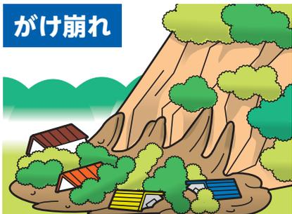
斜面の地表に近い部分が、雨水の浸透や地震などでゆるみ、突然崩れ落ちる現象です。崩れ落ちるまでの時間が短いため、人家の近くでは逃げ遅れも発生し、人命を奪うことがあります。
