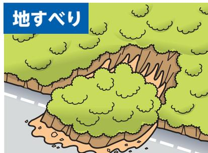
斜面の一部あるいは全部が、地下水の影響と重力によってゆっくりと斜面下方に移動する現象です。土塊の移動量が大きいため、甚大な被害が発生します。
