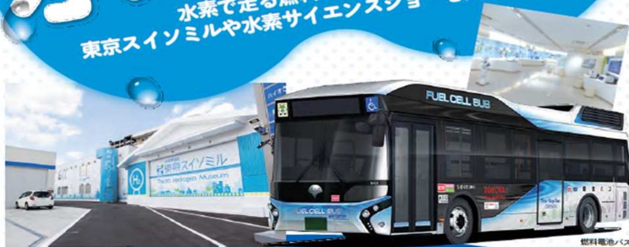
燃料電池バス (水素で発電して走るバス)
