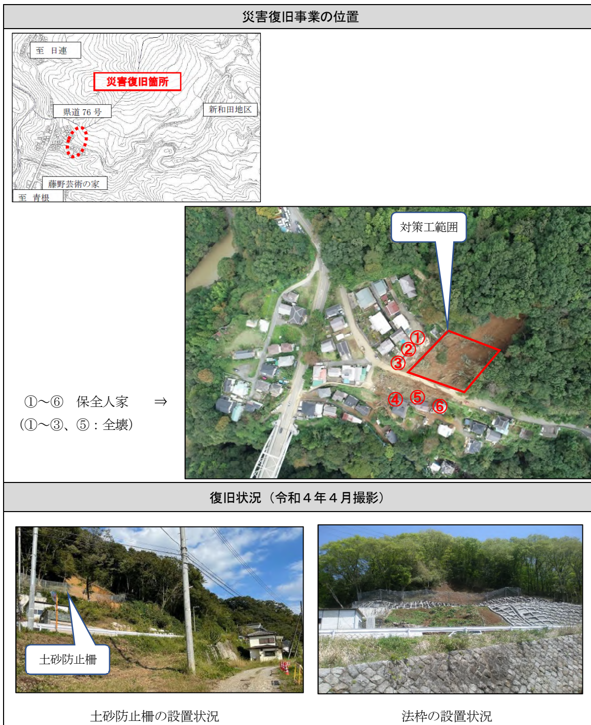
図表 4.8.15 上野久保地区の災害復旧の状況
