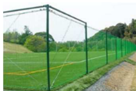
樹脂製防球ネットフェンス ボール遊び程度の場合3～5mが一般的
