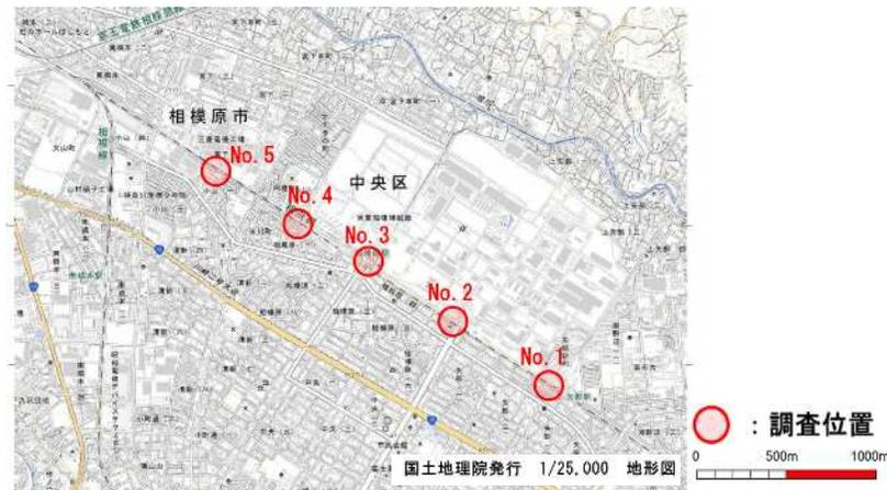
調査の結果、地表からの深さが約17m以深の相模野礫層が、支持層及び耐震設計上の基盤面となることが確認された。なお、支持地盤が比較的深いことから、構造物に対しては杭基礎が有効となる。また、地下構造物の検討において重要となる地下水の影響については、調査区間内には飽和した地下水は分布していないと判断された。
