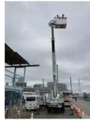
高所作業車 (東京電力ＰＧ)
