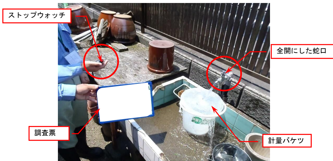
図 2-4：井戸水量計測実施の様子
