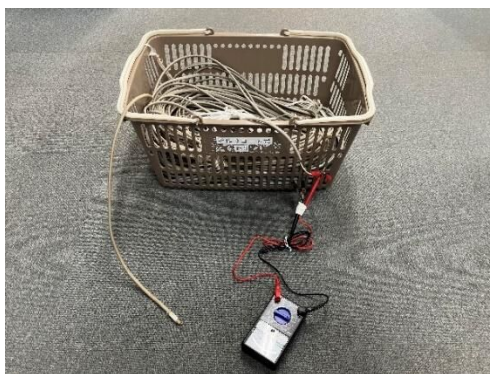
■触針式水位計 (二芯電気ケーブルで自作)
