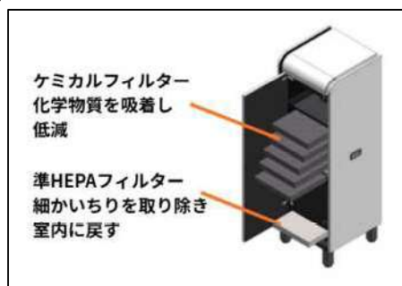
フィルターの仕組み
